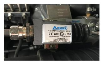
Alle Schaltkreise und Komponenten des Fahrzeugs befinden sich in einem druckfesten Gehäuse.
