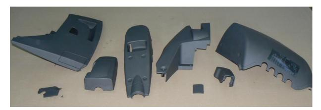
Kunststoffteile am Fahrzeug, mit denen der Bediener in häufigem oder ständigem Kontakt steht, sind wegen der elektrostatischen Gefahr antistatisch ausgerüstet und mit Speziallacken geschützt.
