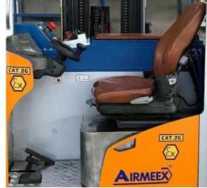
Im täglichen Betrieb sollte der Zustand der oben genannten Teile visuell überprüft werden. Im Falle einer Abnutzung der Teile oder einer Situation, in der die antistatischen Eigenschaften verloren gehen, sollte das Fahrzeug nicht verwendet werden und es sollte sofort ein von Airmeex autorisiertes Personal kontaktiert werden.
